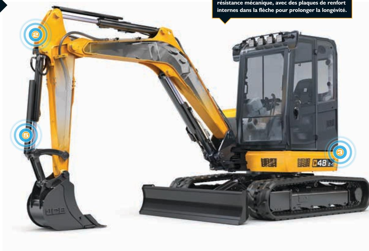
Le balancier et la flèche entièrement soudés par robot sont fabriqués dans un acier à haute résistance mécanique, avec des plaques de renfort internes dans la flèche pour prolonger la longévité.
